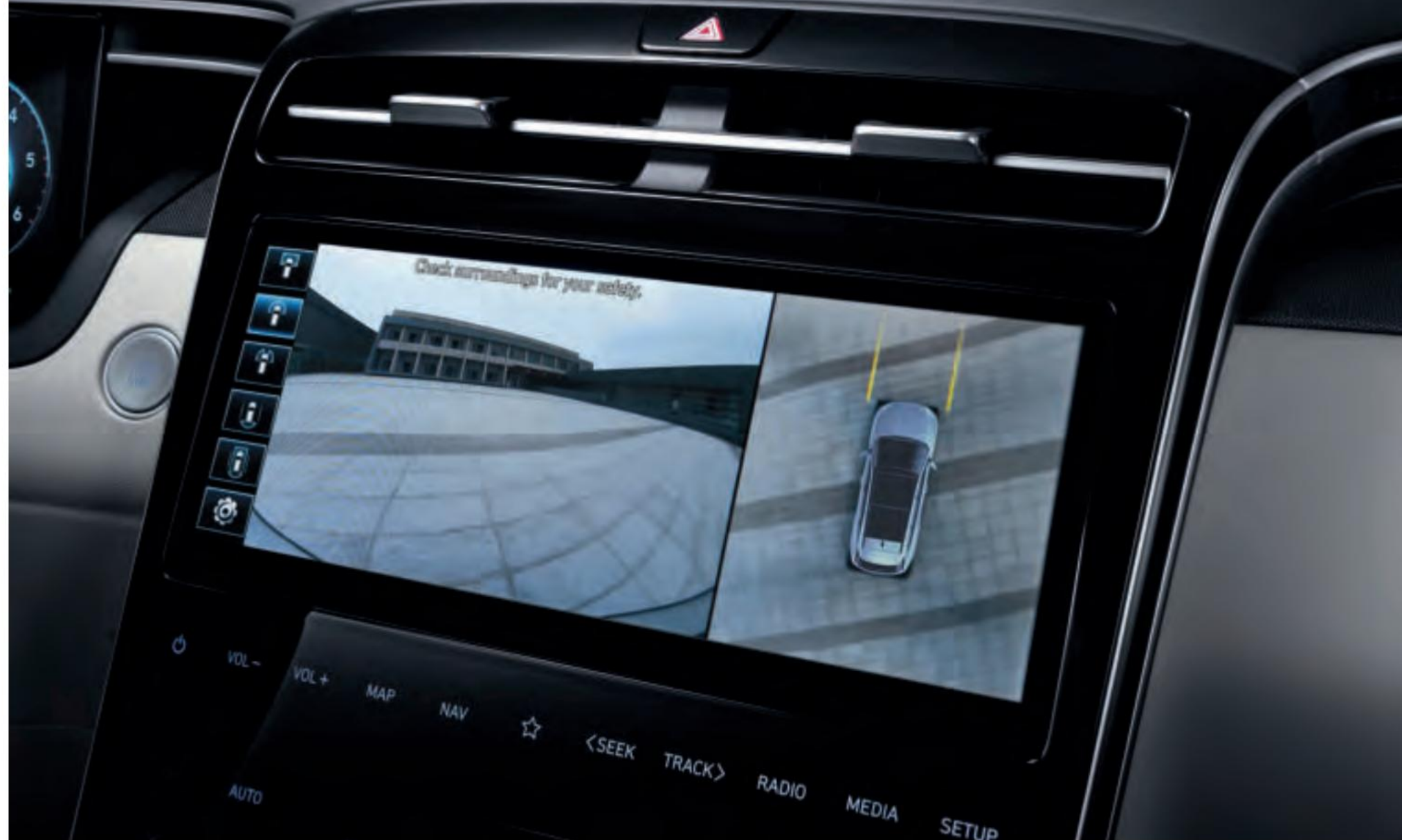
Kamera 360° për të shfaqur hapësirën rreth automjetit. Shijoni shikueshmërinë 360° për parkim më të lehtë dhe më të sigurt. Katër kamera me definicion të lartë të montuara në pjesën e përparme, anësore dhe të pasme të automjetit shfaqin mjedisin në kohë reale.
