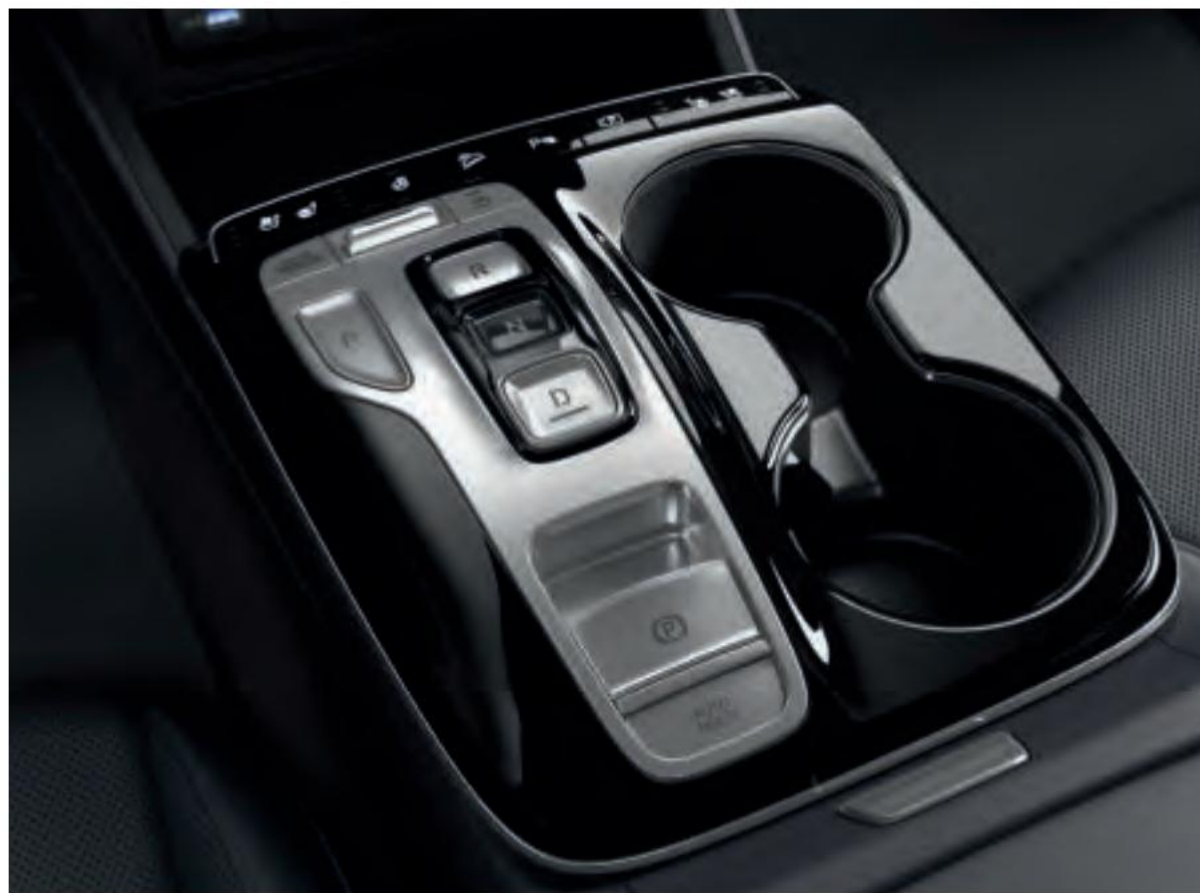
Kuti ingranazhi me butona të tipit Shift-by-wire.
