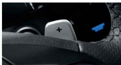
Panel me ndriçim Kuti ingranazhesh sekuenciale me leva në timon (Ndërruesit e marsheve)
