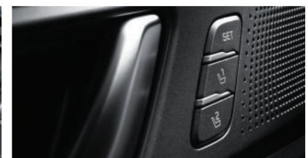
Porta e karikimit USB (konsola qendrore) Sistemi i integruar i memories (IMS)
